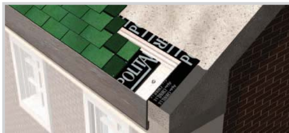
REMATE CON PIEZAMETÁLICA Y LÁMINA DE ADHERENCIA
